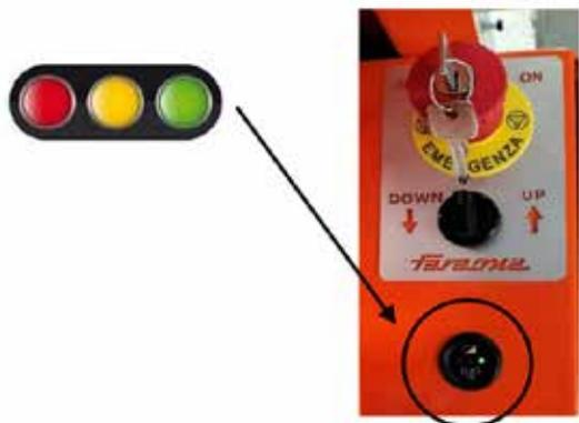
Durante el uso de la máquina, la carga de la batería pasará de la condición de carga completa (indicada por el led verde), a la condición de carga parcial (indicada por el led amarillo), y a la condición de batería baja (indicada por el led rojo).
