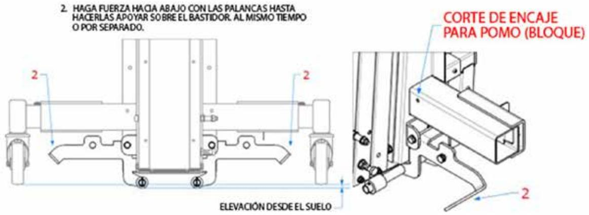
Después de reemplazar los estabilizadores, levante las palancas hacia arriba y fíjelas nuevamente con los pomos en la posición (1).
